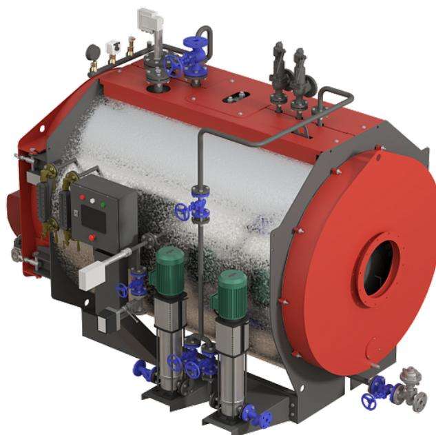
Конструкция: двухходовой с реверсивной топкой, расположенной ниже центра корпуса котла.
