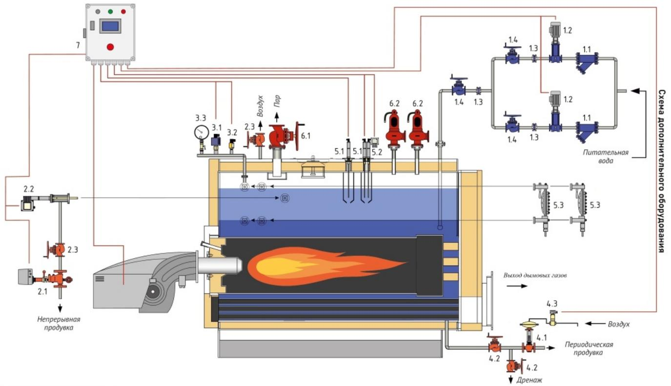
Схема Дополнительного оборудования
